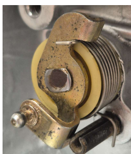
Detailansicht des montierten Federpaketes der Resonanzklappe.
